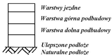
Rys. 3. Konstrukcja nawierzchni utwardzonego pobocza
